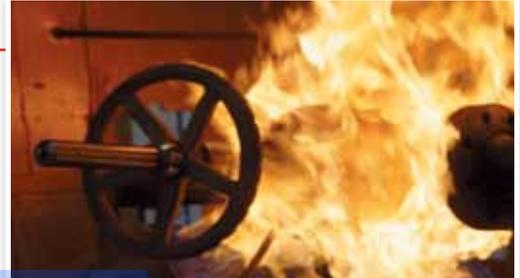
**Prueba de Fuego.**- Se cuenta con instalaciones apropiadas para ejecutar la prueba de fuego de acuerdo a los requerimientos de API. Esta prueba expone la válvula a fuego de 1,400°F a 1,800°F (761°C a 980°C) para verificar la hermeticidad y sello adecuado de la válvula, después de cierto tiempo de exposición.
